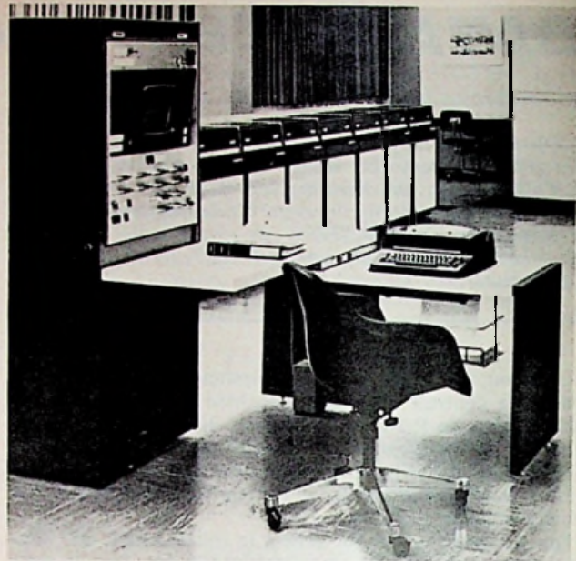
Centrale machine P1100 met console typewriter en een aantal magnetische schijveneenheden.
