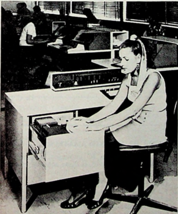
Tape encoder waarmee het mogelijk is gegevens, via een toetsenbord, direct op magnetische band vast te leggen.
