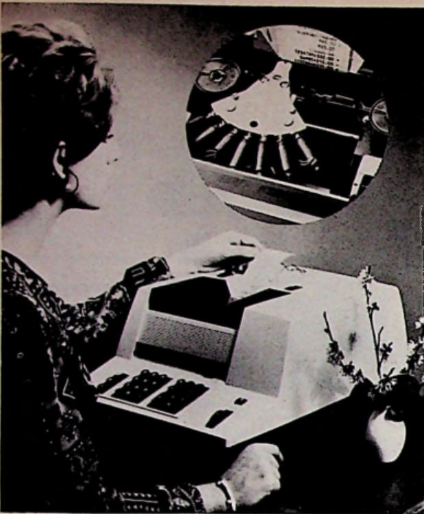
Tafelrekenautomaat P252, geschikt voor meer ingewikkelde technische en wetenschappelijke berekeningen, dankzij een automatische inrichting voor vierkantworteltrekken en een tweede werkgeheugen. Inzet: de mozaïek schrijfkop.
