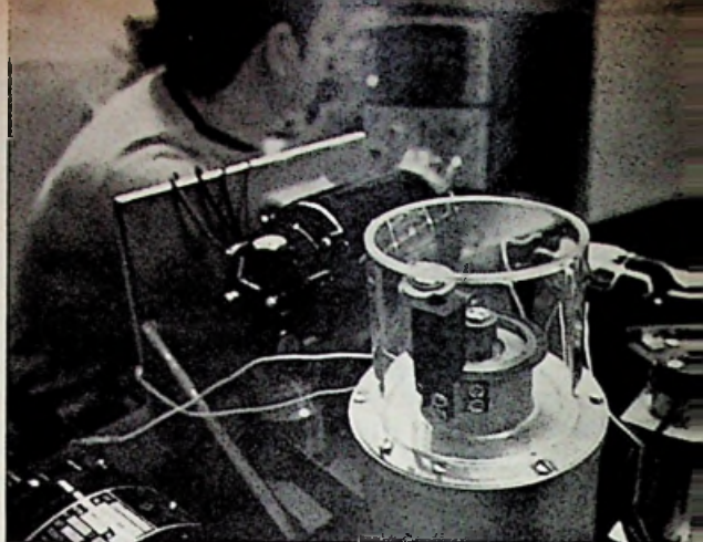
Een technicus test het mechanisme van de filmtransporteur, die de film met 10 000 regels per minuut verplaatst.
