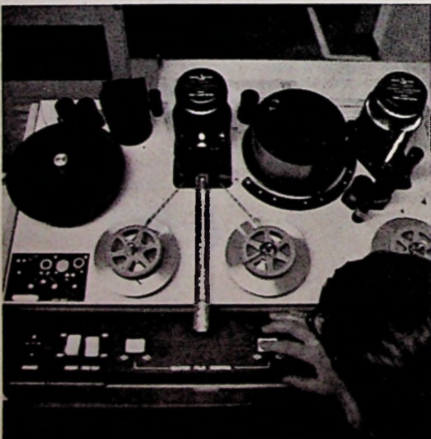
De Memorex 1620 film duplicator vermenigvuldigt opnamen van computer uitvoergegevens op COM-T microfilm, die met warmte ontwikkeld wordt waardoor een vloeibare ontwikkelaar overbodig is.
